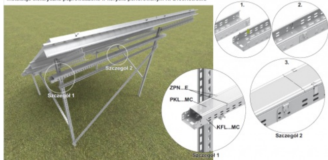
Instalacja elektryczna poprowadzona w korytku perforowanym KFL100H60/3MC
