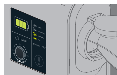
"Charge terminée" (vert fixe) "Ładowanie kompletne" (zielone świecenie wskaźnika)
