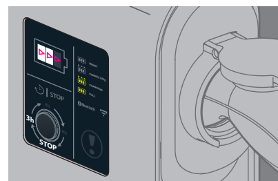
Borne en attente de départ différé (défilement blanc) Voyants "3h" (ou 6h ou 9h) et stop allumés (blanc fixe) Ładowarka oczekuje na opóźniony start (białe przewijanie wskaźnika) Wskaźniki "3h" (lub 6h lub 9h) i stop świecą (białe świecenie)
