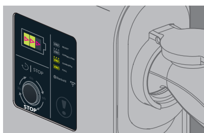
"Charge du véhicule" (défilement vert) "Ładowanie pojazdu" (zielone przewijanie wskaźnika)
