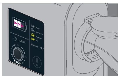
"Borne connectée au véhicule" en attente de charge (défilement blanc) (0 à 30" selon véhicules) "Pojazd przyłączony do ładowarki" oczekiwanie na ładowanie (białe przewijanie wskaźnika) (0 do 30 min w zależności od pojazdu)
