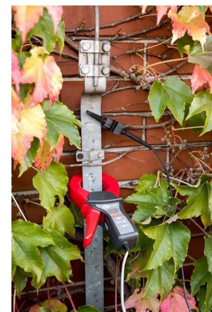
El hueco (formado de las superficies del núcleo) debe mantenerse perfectamente limpio.
